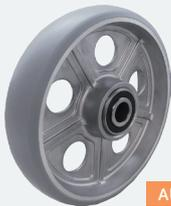
重量物でも軽く動かすことができる、高品質なウレタン車輪です。運搬時に一番重く感じる初期動作を改善し、方向転換時のスムーズな旋回性能を実現します。高強度のウレタンと摩擦係数の小さい車輪形状を採用し、接地面が小さく保たれるため重量物でも軽く動かすことができます。
