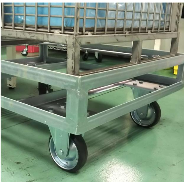
ボックスパレットを安全に運搬できる専用台車です。中身を移し替えることなく、そのまま運搬することができます。寸法変更、その場旋回の機能付きや、かさ上げによる高さの調節など、ご要望に応じてカスタム可能です。連結器を取り付けてけん引仕様にすることも可能です。
