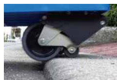
02.前輪が路面を押す力に変換
