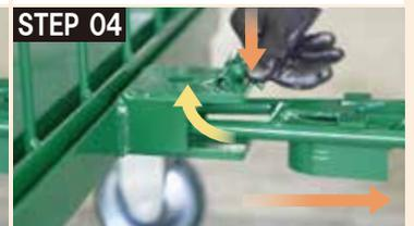
STEP 04 解除する際は連結器メス側のピンを指で押し上げて、オス側を引き抜けば解除できます。
