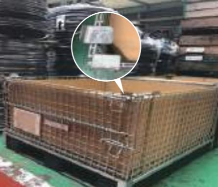
既存の平パレットを保管が乱雑になりがちなコントロールケーブルの保管用途に流用。特長は上部にある受け金具です。受けを付けることで、段積みを安全に効率よく行えるように設計しています。
