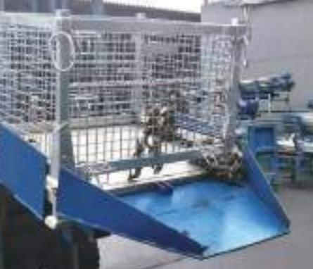
フォークリフトにお客様特製の専用器具を装着し、パレットを固定。フォーク部を下げる底を開くことで、足場材のジョイント部品を速やかに取り出し、洗浄機へ移し替える際に使用しています。このパレットを導入したことでの作業時間が20分から5分に縮まり効率化を図ることができました。
