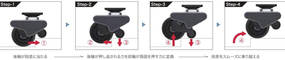
後輪が段差に当たる → 後輪が押し返される力を前輪が路面を押す力に変換 → 段差をスムーズに乗り越える
